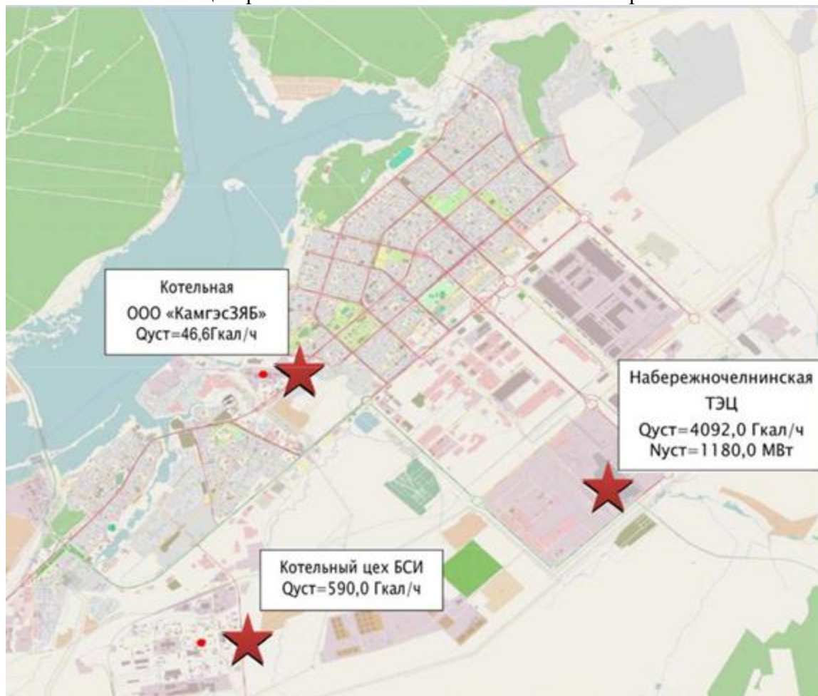
Рис. 2.1. Источники централизованного теплоснабжения г. Набережные Челны
