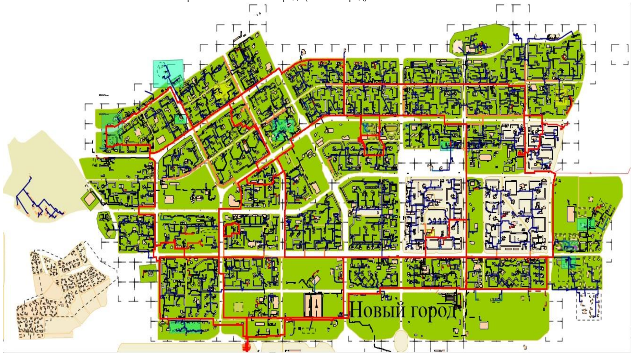
Рис. 4.2 Схема тепловой сети Северо-восточной части города (Новый город)
