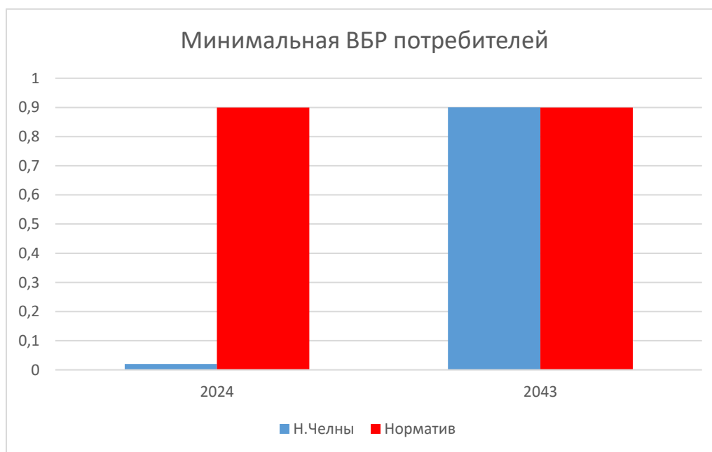
Рис. 4.2. Сравнительный анализ нормативного и фактического минимального показателя ВБР потребителей тепловодов НЧТЭЦ АО «Татэнерго» до 2043 года
